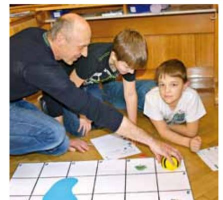
Mit insgesamt sieben Tasten, die direkt auf der BeeBot angebracht sind, kann die „Biene“ programmiert werden, um einfache Bewegungsabläufe auszuführen. Durch das Arbeiten machen die Kinder auf einfache und sehr spannende und lustige Weise erste Erfahrungen zum Programmieren von Robotern und Computern. Sie sammeln Routine im analytischen und logischen Denken, entwickeln Strategien und müssen Vorausdenken, um die BeeBot zielgerichtet steuern zu können.
